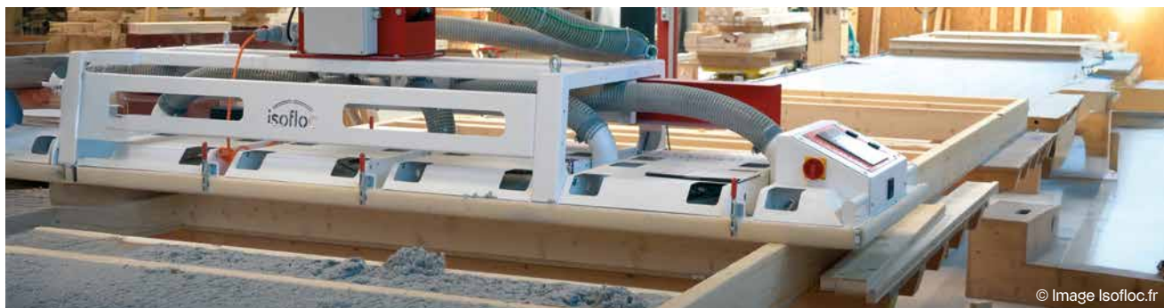
Fabrication en atelier des murs et isolation ouate de cellulose isofloc
