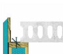
3 - pose de la dalle alvéolaire précontrainte
